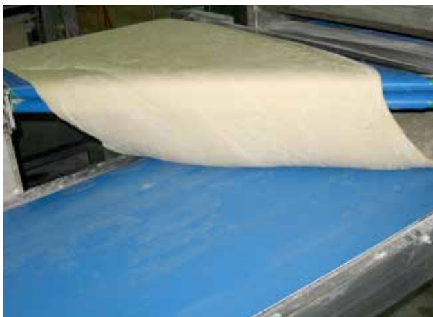
Transporte de la masa con sistema de descarga a 45° sobre doble cuchilla fija
