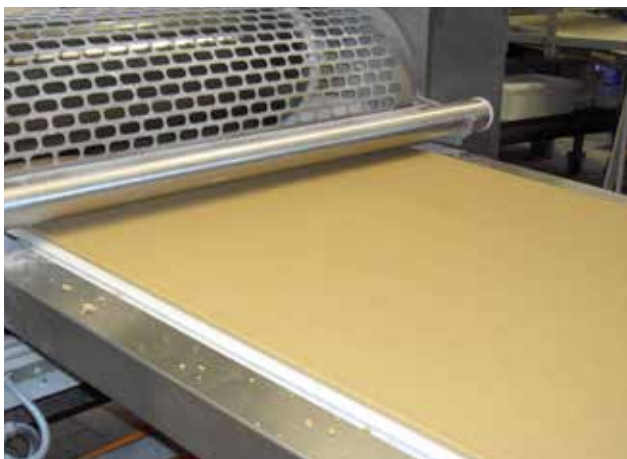
Laminador de masa para producción de hojaldré
