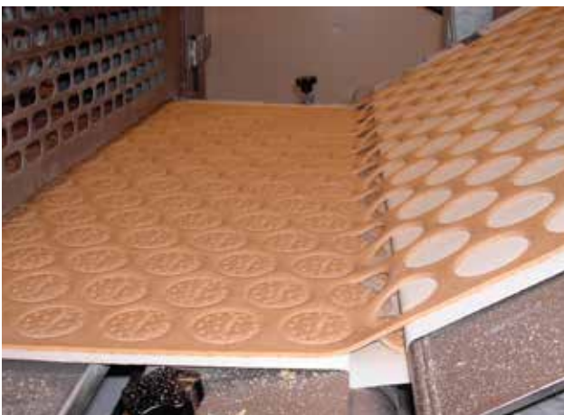
Corte rotativo y recuperación de residuos de retales
