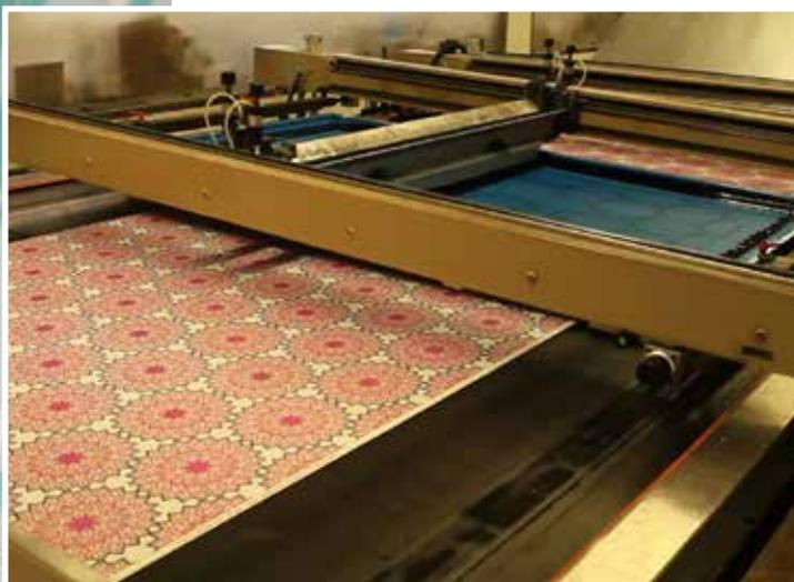
X-Motion® è un nuovo concept di nastro per macchine da stampa digitale, a rulli o a quadri piani. La **struttura tessile inestensibile** evita ritensionamenti e fermi macchina. Lo **speciale poliuretano termoplastico** offre elevata resistenza agli agenti chimici e alla temperatura, garantendo una lunga durata del nastro.
