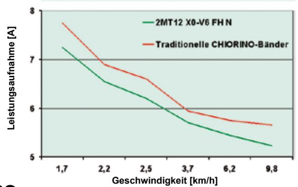
Vergleich geschwindigkeitsabhängiger Leistungsaufnahme
