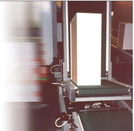
Während der abschließenden Verarbeitungsschritte werden die Möbelteile zur Montage von verschiedenen Komponenten mit Hilfe von ZWINGEN zusammengepresst. Die eingesetzten Transportbänder **2M8 U0-V5 FM** und **2M12 U0-V3** als Beschickungsbänder bieten den notwendigen Reibwert und hohe Abriebfestigkeit zum reibungslosen Ablauf dieses anspruchsvollen Material-Weitertransports.
