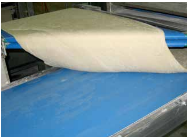
Trasporto pasta con sistema di scarico a 45° su doppia penna fissa
