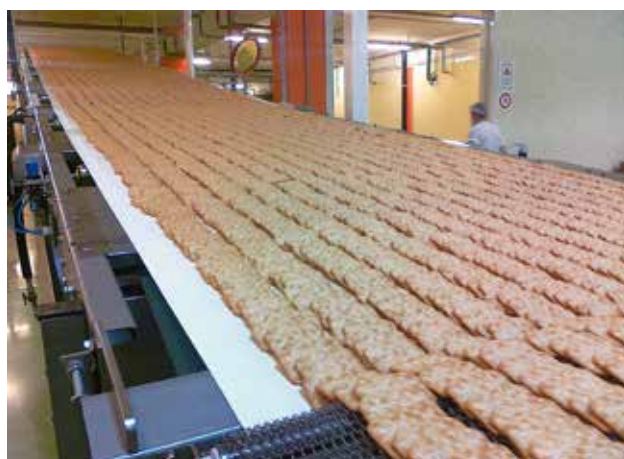
Linea di raffreddamento crackers
