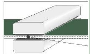
2. Entnahme des Bandes aus der Presse erst nach Beendigung des Kühlprozesses.
