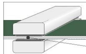
2. Entnahme des Bandes aus der Presse erst nach Beendigung des Kühlprozesses.
