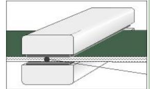
2. 在取出接头之前, 必须完成冷却程序。
