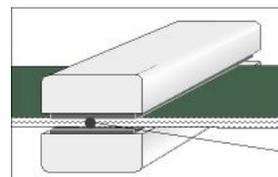
2. 在取出接头之前, 必须完成冷却程序。
