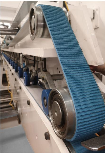
I nastri Chiorino HS<sup>®</sup> blue sono studiati per offrire **altissima resistenza all'abrasione** e per **aumentare l'efficienza produttiva**. L'interply in TPU termoplastico permette una rapida chiusura sul posto **riducendo al minimo il downtime**.
