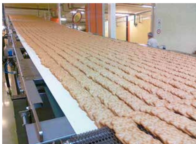
Ligne de refroidissement de biscuits salés
