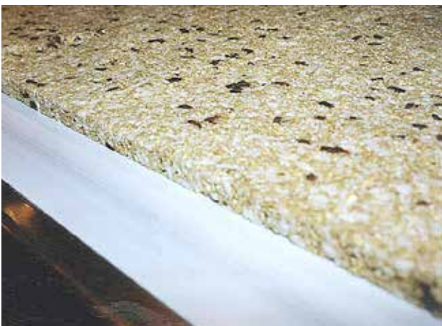
Transport de muesli sur bande déadhésive
